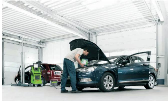
Dodatno FSA 720/740 može se kombinirati s novim i postojećim KTS560/590 dijagnostičkim uređajima, za praktično pokazivanje stvarnih vrijednosti iz ECU dijagnoze u FSA softveru, povezano s KTS modulom.
