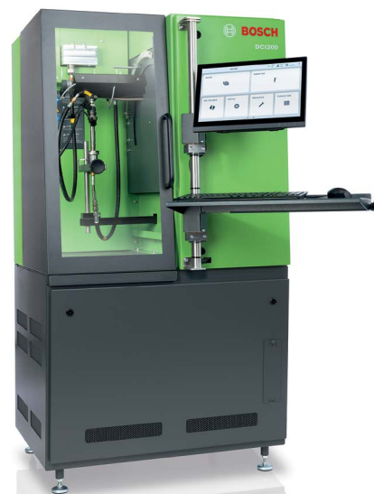
Bosch DCI 200 testerom proširuju se mogućnosti testiranja pojedinačnih injektora u svakom autoservisu
