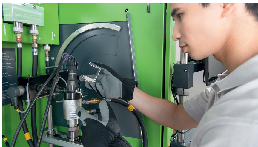
Bosch DCI 200 testerom proširuju se mogućnosti testiranja pojedinačnih injektora u svakom autoservisu
