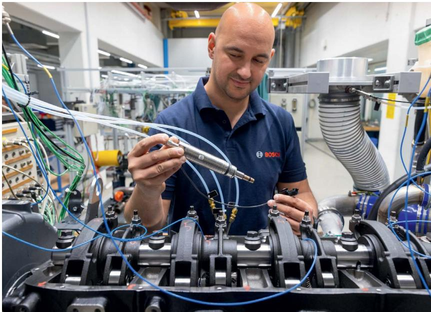
Ispitivanja s novim ubrizgivačem za izravno ubrizgavanje vodika, koji je Bosch prvi put predstavio na sajmu Agritechnica 2023. u Hannoveru, Njemačka.
