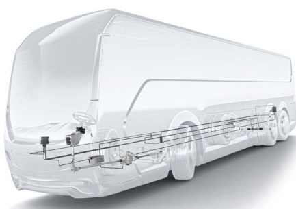
Upravljački sustav za gospodarska vozila s upravljanjem stražnjom osovinom
