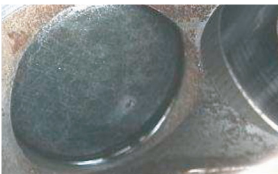
Korozija na kućištu visokotlačne pumpe
