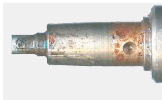
Korozija na ubrizgaču
