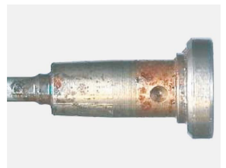
A befecskendező korróziója
