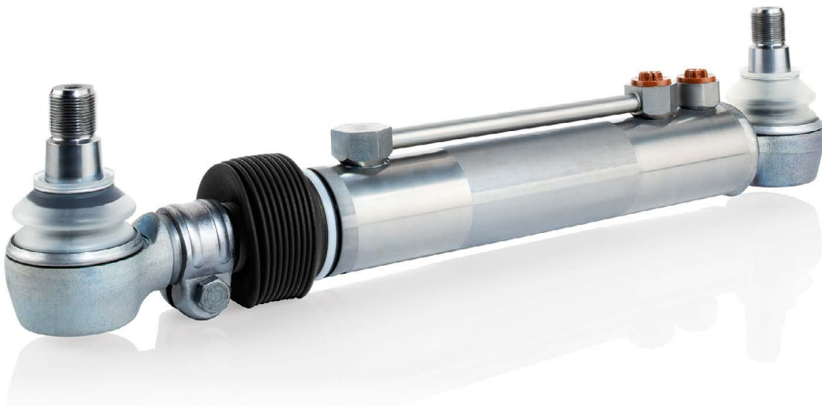
Bosch munkahenger haszongépjárművek kormányműveihez
