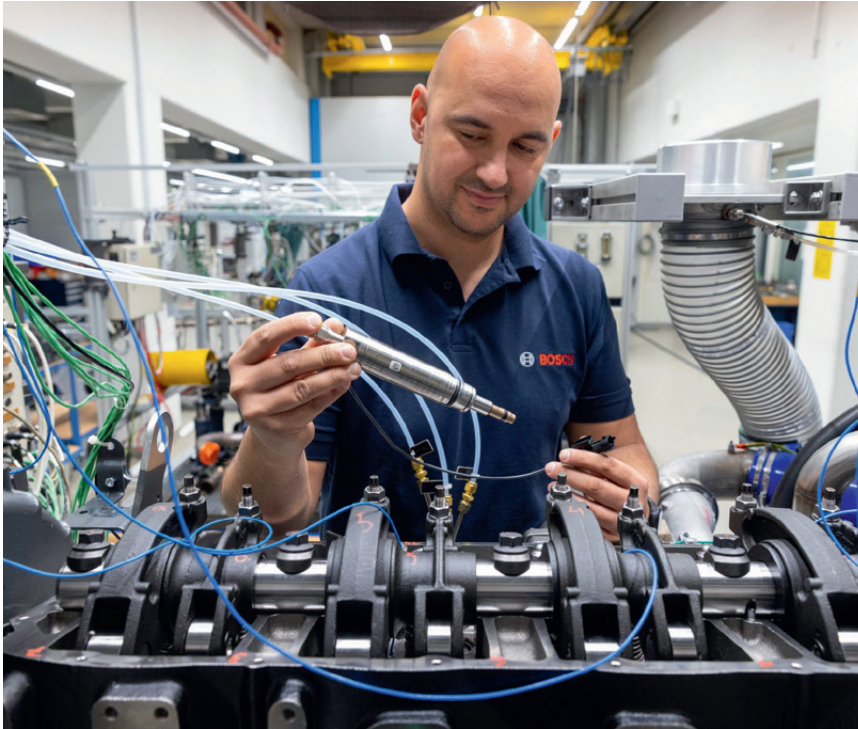
A Bosch által először a hannoveri Agritechnica 2023 kiállításon bemutatott új, közvetlen hidrogénbefecskendezésű injektorral végzett tesztek.
