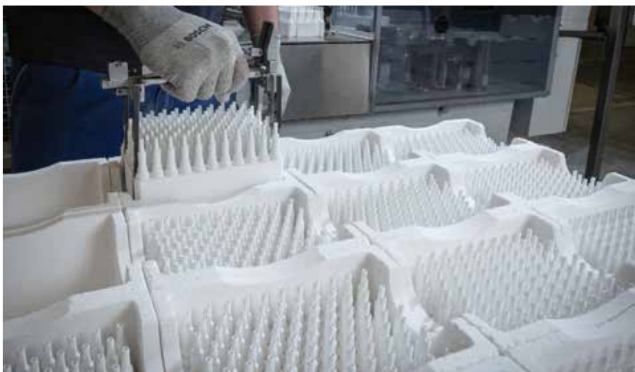
A lágy szigetelők behelyezése az égési kapszulákba
