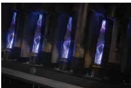
A kerámia hibátlanságának elektromos vizsgálata
