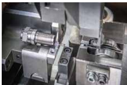
A testelektróda előkészítése a nemesfémötvözet hegesztéséhez
