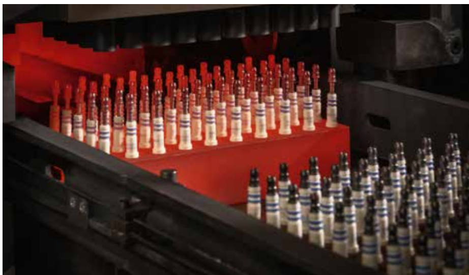
A gyújtógyertya csatlakozó részének benyomása folyékony üvegmasszába
