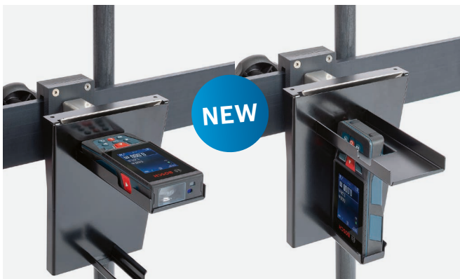
Regolazione dell'altezza da terra e misurazione della distanza dal sensore radar digitali tramite laser
