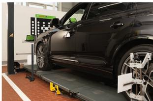
Ponti sollevatori: Offset di sistema per compensazione della differenza di altezza e visualizzazione dell'angolo di imbardata.
