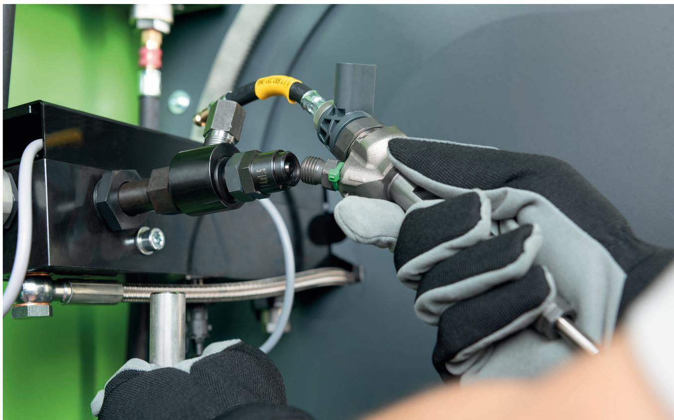
I più recenti standard sulle emissioni di gas di scarico e le future direttive aumentano l'importanza di testare gli iniettori common-rail nei moderni motori diesel. Per questo, quanto più precisa è la misurazione tanto più accuratamente si può adattare l'iniettore.
