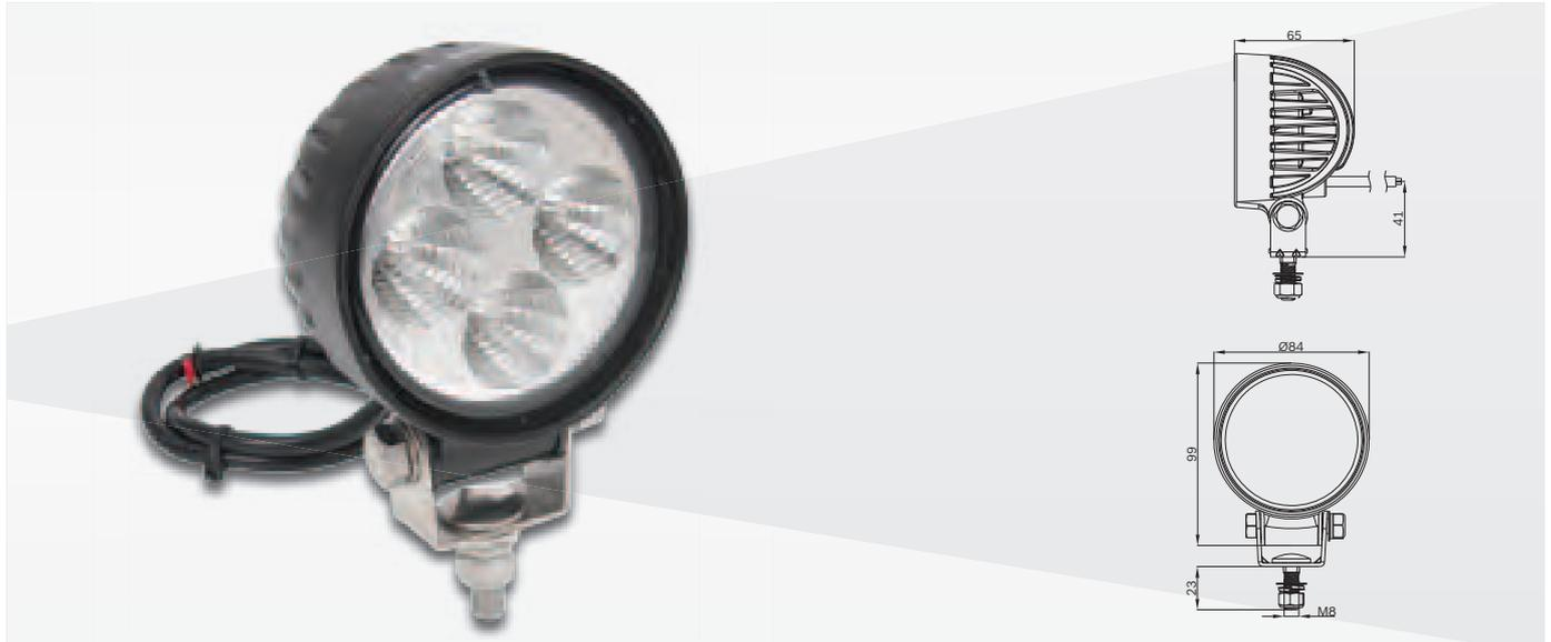
**Faro da lavoro LED rotondo con un consumo di corrente da 12 W. Il faro da lavoro è provvisto di 4 LED ad elevata potenza. La potenza luminosa effettiva è di 600 lumen sia per fari a 12 che a 24 volt. Soppressione dei disturbi a norma ECE R10 (EMC), Grado di protezione IP67.**
