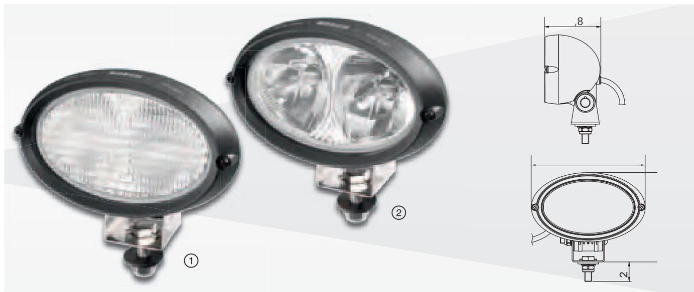
Per tutti coloro che hanno bisogno di molta luce ma dispongono di poco spazio per fari supplementari. Versione Double Beam con due sorgenti luminose per una potenza supplementare. A scelta faro da lavoro con cono di luce largo o faro da ricerca con cono di luce stretto e portata lunga. Per 12 V con 55 W o 24 V con 70 W di potenza. Tipo di protezione IP6K9K.
