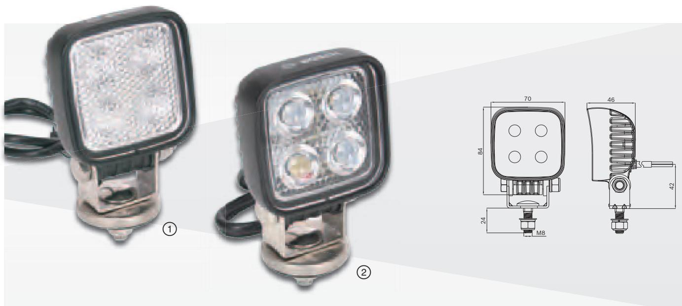
**Faro a LED piatto con potenza da 12 W.** Disponibile sia come faro da lavoro che combinato. Entrambi i proiettori sono provvisti di 4 LED ad elevata potenza. La potenza luminosa effettiva è di 600 lumen sia per fari a 12 che a 24 volt. Soppressione dei disturbi a norma ECE R10 (EMC), Grado di protezione IP67.
