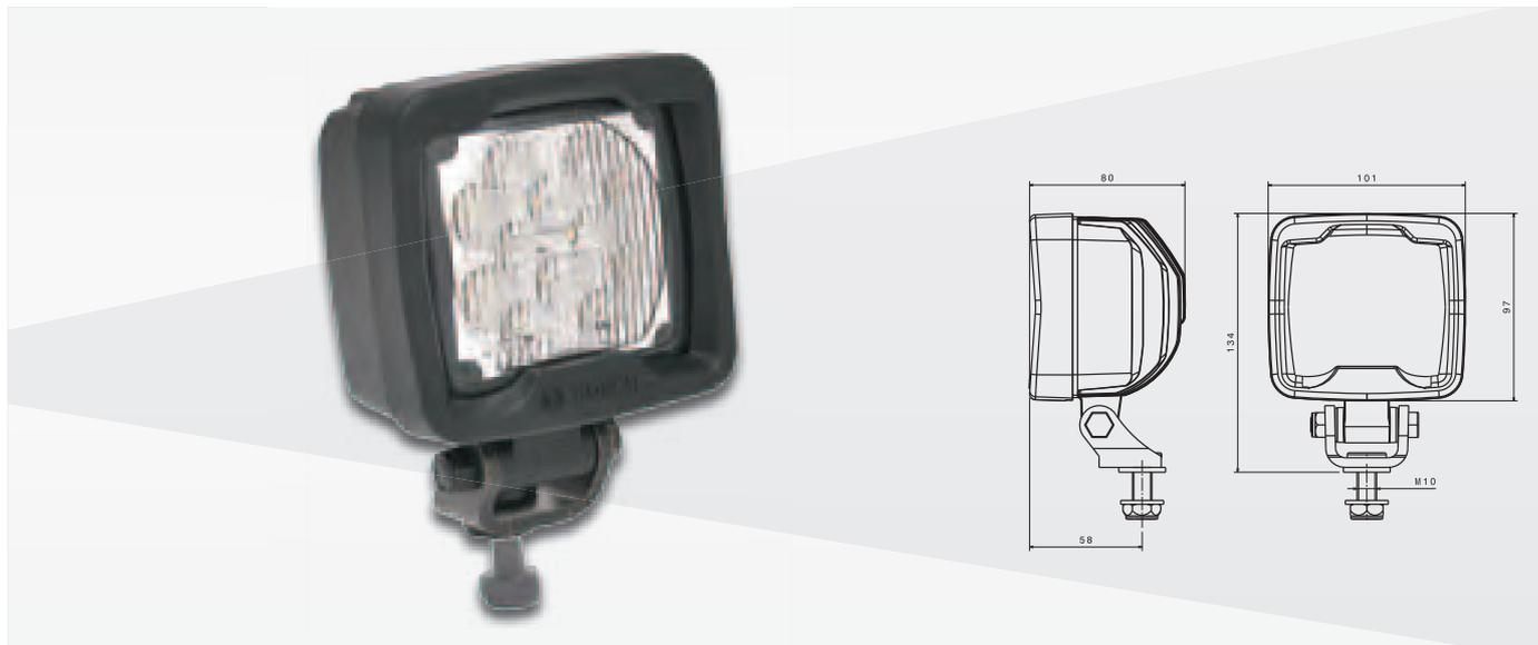
**Faro Heavy Duty a LED di qualità OE con lente di vetro temprato. Consumo 11 W, con 12 LED ad alta potenza, adatto a tutte le polarità. Il faro, resistente agli urti e alle vibrazioni, è particolarmente adatto per le condizioni più difficili nell'industria mineraria e nei cantieri edili. Il flusso luminoso effettivo è di 850 lumen. Migliori prove EMC come definito nel regolamento ECE R10. Opzionale 12 o 24 V. Tipo di protezione IP68/IP69K.**
