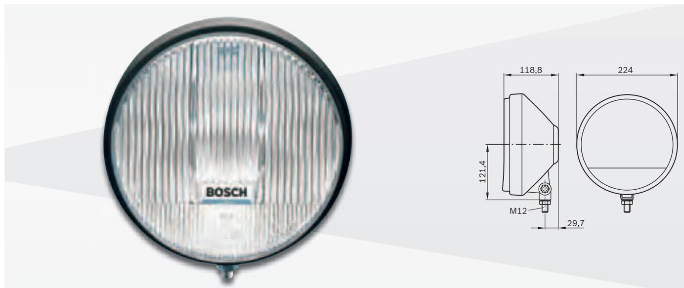
**Faro supplementare robusto, sviluppato appositamente per l'impiego nei rally. Ottima visibilità e illuminazione della carreggiata per gli impieghi più duri.**
