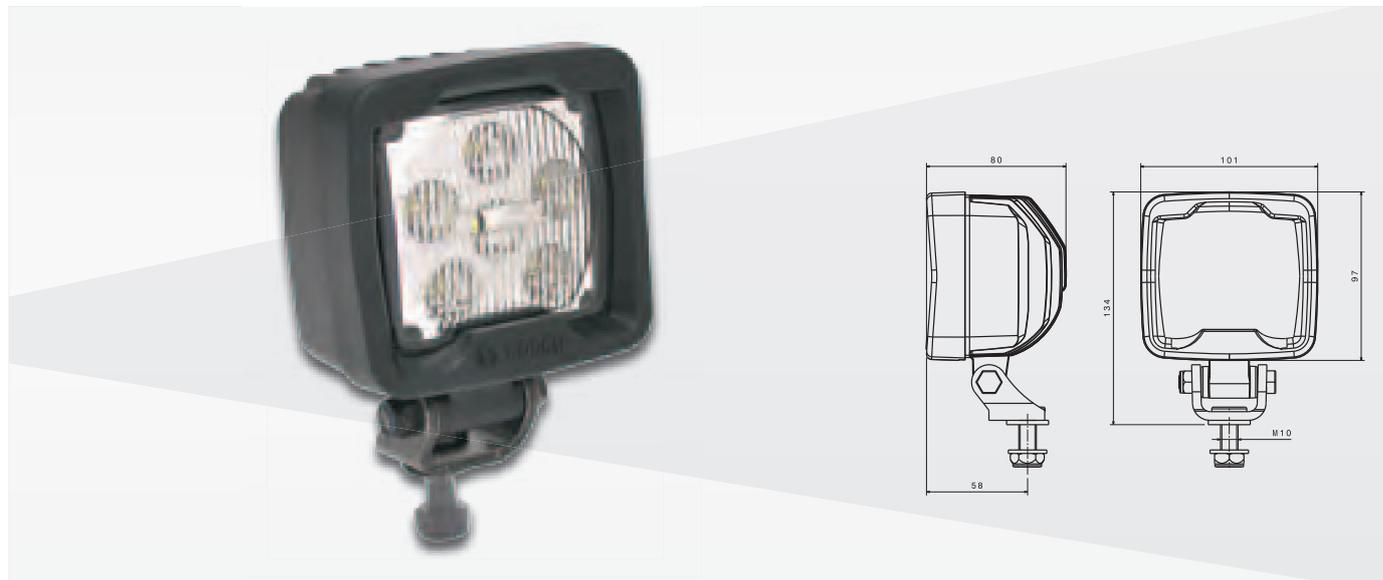
**Faro Heavy Duty a LED** di qualità OE con lente di vetro temprato. Consumo 28 W, con 6 LED ad alta potenza, adatto a tutte le polarità. Il faro, resistente agli urti e alle vibrazioni, è particolarmente adatto per le condizioni più difficili nell'industria mineraria e nei cantieri edili. Il flusso luminoso effettivo è di 2.000 lumen. Migliori prove EMC come definito nel regolamento ECE R10. Opzionale 12 o 24 V. Tipo di protezione IP68/IP69K.
