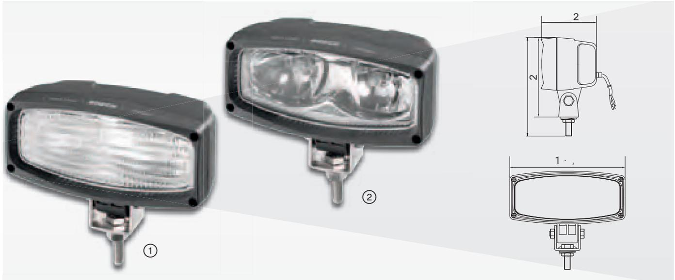
Ideale per tutti coloro che vogliono il massimo dai propri fari da lavoro o da ricerca. Versione Double Beam con due sorgenti luminose per una potenza supplementare. Per 12 V con 55 W o 24 V con 70 W di potenza. Tipo di protezione IP6K9K.
