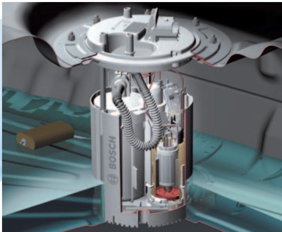
In den Anfängen der elektronischen Benzineinspritzung befand sich die Elektrokraftstoffpumpe in der Kraftstoffleitung („inline“). Heute überwiegt der Einbau im Tank („intank“). Sie ist Bestandteil einer Tankeinbaeinheit (Fördermodul), in die weitere Funktionen wie Kraftstofffilter, Druckregler und Elektronikmodule integriert werden können.
