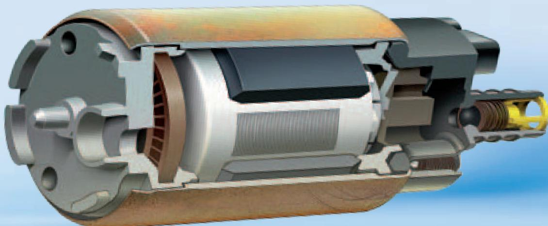
Die Elektro-Kraftstoffpumpe (EKP) muss dem Motor bei allen Betriebszuständen ausreichend Kraftstoff mit dem zum Einspritzen nötigen Druck zuführen. Außerdem dient sie zunehmend als Vorförderpumpe für moderne Direkteinspritzsysteme sowohl für Benzin- als auch für Dieselmotoren.
