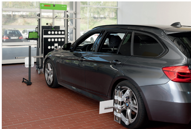
BMW/Mini e Gruppo VW: posizionamento estremamente preciso rispetto all'asse di guida comprensivo di impostazione della distanza specifica. Pannello VW / Riflettore multi-radar installato verticalmente e centrato di fronte al sensore Radar.
