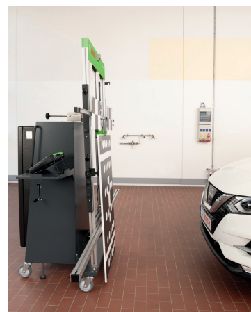
Calibrazione del radar 3-punti: posizioni di inclinazione secondo i requisiti OEM: + 2°, 0°, -2°
