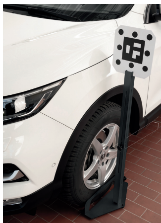
Radar + telecamera frontali Nissan: la misurazione software della distanza dimostra la propria massima efficienza soprattutto a distanze di 2-4 metri. Ciò costituisce un valore aggiunto per la produttività dell'officina. Supporto alla misurazione della distanza con puntatore per riferimento centro-ruota.
