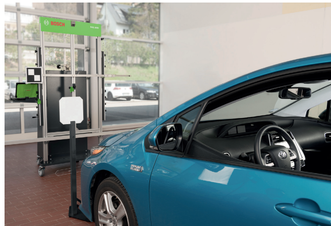
Telecamera frontale Toyota: calibrazione sequenziale con uno o più pannelli. Posizionamento estremamente preciso del riferimento per la misurazione della distanza in base ai requisiti OEM.
