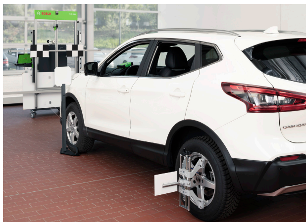
Radar + telecamera frontali Nissan: la misurazione software della distanza dimostra la propria massima efficienza soprattutto a distanze di 2-4 metri. Ciò costituisce un valore aggiunto per la produttività dell'officina. Supporto alla misurazione della distanza con puntatore per riferimento centro-ruota.
