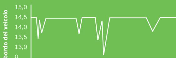
Sforzo della batteria in caso di sistema start/stop
