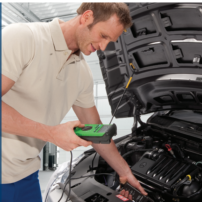
Test della tensione (MMD 302): La candele va sostituita
