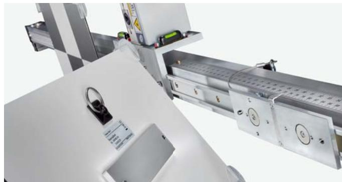
磁気クランプを使用して、ターゲットを精密スライダーに差し込みます。
