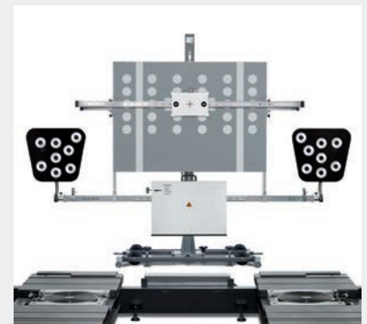
Z przyrządem do geometrii typu 3D (tu przykład tablic kalibracyjnych dla Mercedes)
