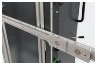
Precyzyjna belka pomiarowa do mocowania tablic kalibracyjnych
