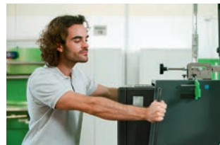
Ergonomiczne i wygodne manewrowanie dzięki bocznym uchwytem i szybkiej regulacji kąta nachylenia (+/- 2 stopnie)
