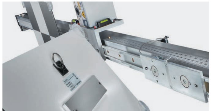
Tablicę kalibracyjną wystarczy zawiesić na sankach uchwytyami magnetycznymi
