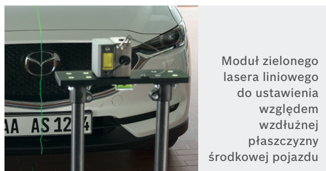
Regulacja wysokości od podłoża za pomocą lasera
