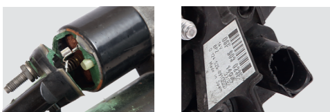
uszkodzenie plastikowej części przełącznika zatężającego
