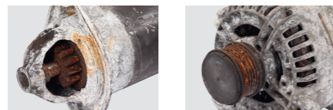
znacząca korozja zębika lub obudowy
