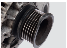
uszkodzone koło pasowe
