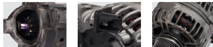
fioletowy nalot na osi, ślady przegrzania
