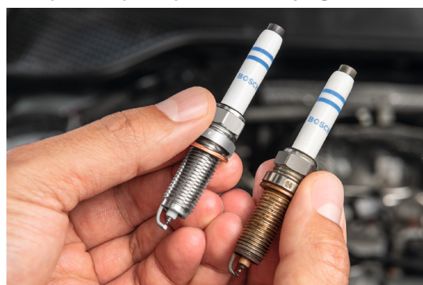
Porównanie używanej i nowej świecy zapłonowej
