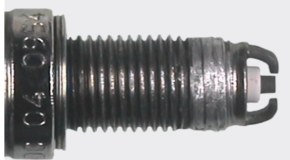
Stopione aluminium głowicy cylindrów w stalowym gwincie świecy zapłonowej
