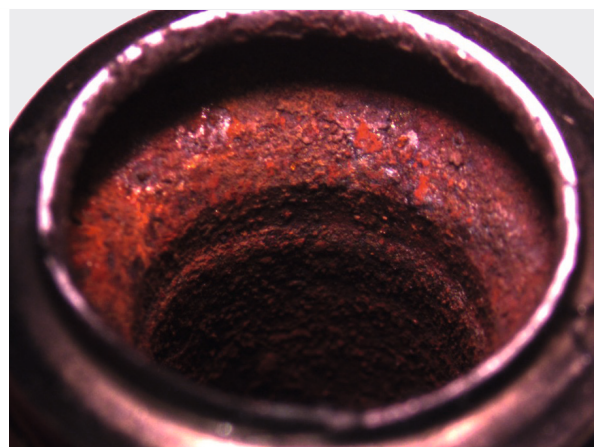
Koroza wewnątrz świecy zapłonowej spowodowana brakiem szczelności
