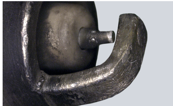
Elektrody uszkodzone przez czyszczenie szczotką drucianą
