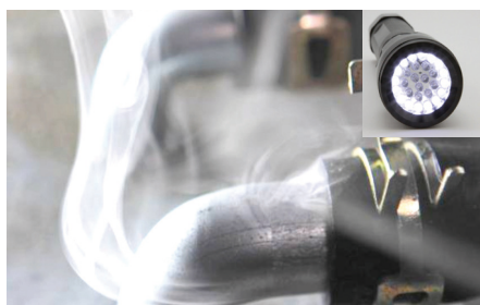
As fugas podem ser identificadas facilmente através da luz branca
