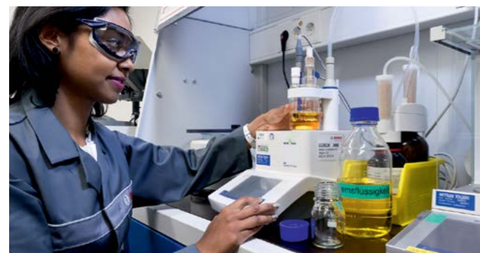
Resultados de teste de ENV6 da Bosch no laboratório: no centro de desenvolvimento da Bosch em Abstatt, o líquido de travões é submetido a testes químicos.
