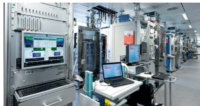
Bancos de teste em funcionamento contínuo no laboratório de alta tecnologia: com a sua elevada dinâmica, o ENV6 contribui para um alto desempenho e durabilidade dos sistemas de travagem modernos.
