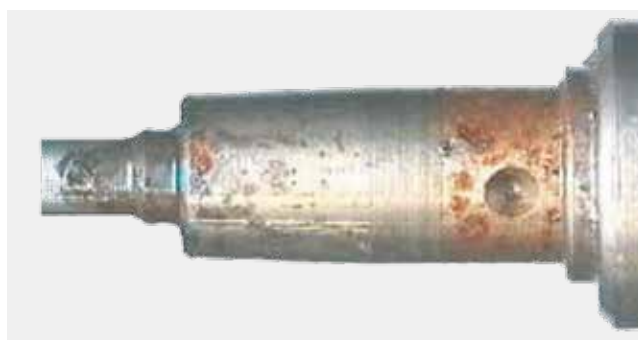
Corrosão no injetor
