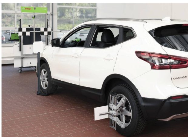
Senzori radar + cameră față Nissan: software-ul de măsurare a distanței își demonstrează avantajele în special la distanțe de 2-4 metri. Astfel, este asigurată o eficiență mai mare a service-ului auto. Sistem de asistență pentru măsurarea distanței cu indicator de referință pentru centrul roții.
