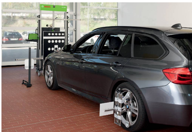
BMW/Mini și Grupul VW: poziționare de mare precizie în funcție de axa directoare, inclusiv configurarea specifică a distanței. Panoul țintă VW instalat vertical și central în fața senzorului radar.
