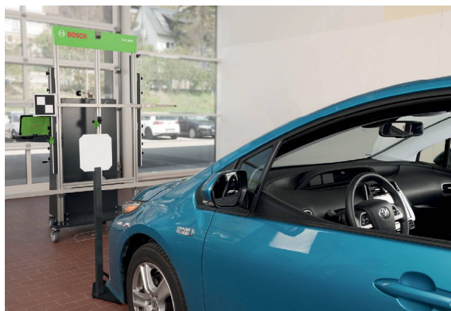
Camera frontală Toyota: calibrare secvențială cu una sau mai multe ținte. Poziționare de mare precizie a sistemului de asistență pentru măsurarea distanței în conformitate cu cerințele OEM.
