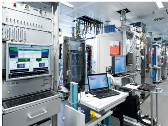
Bancuri de testare cu funcționare continuă la laboratorul de înaltă tehnologie: cu o înaltă dinamică, ENV6 contribuie la creșterea performanței și a duratei de viață a sistemelor moderne de frânare.
