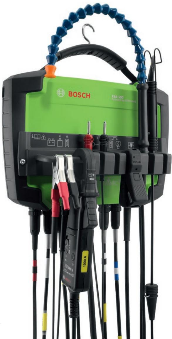
Prigodni FSA 500 omogućuje više od 30 predefinisanih testova komponenata i lako je uklopljen kao nadogradnja u postojeća dijagnostička rešenja u radionicama. Njegova prednost krije se u sposobnosti jednostavnog ispitivanja električnih i elektronskih komponenata.
