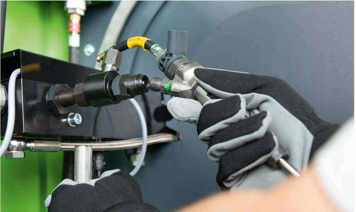
Najnoviji standardi i buduće direktive za emisiju izduvnih gasova povećavaju značaj testiranja common-rail injektora u savremenim dizel motorima. Iz tog razloga, što je merenje preciznije, injektor im se može preciznije prilagoditi.
