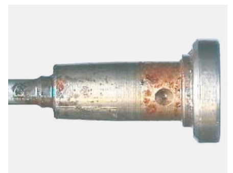
Korozija na injektoru
