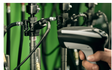
QualityScan: za identifikaciju injektora skener očitava odgovarajući matriks kod
