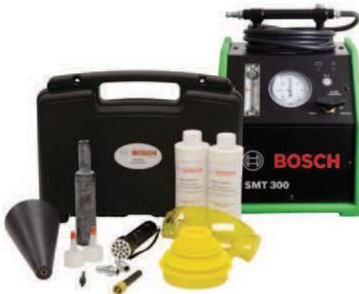
Kada se ispituju curenja u sistemu za ubrizgavanje goriva, može se koristiti samo inertni gas (nestišljiv, azot ili CO<sub>2</sub>). "Set inertnog gasa" (boca za gas pod pritiskom i adapter) se može poručiti odvojeno. Boca za gas pod pritiskom se isporučuje prazna i mora se napuniti od strane specijalizovanog dobavljača za inertne gasove.
