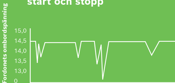
Belastning av batteriet i händelse av start/stopp
