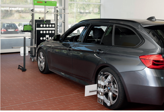
BMW/Mini ve VW Grubu: Belirli mesafe ayarı dahil tahrik eksenini yönünde son derece hassas yerleştirme. Dikey olarak monte edilmiş ve Radar sensörünün önüne ortalanmış VW Hedefi.
