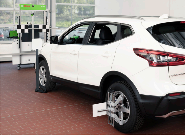
Nissan ön radar + kamera: Yazılım tabanlı mesafe ölçümü, özellikle 2-4 metre mesafelerde son derece kullanışlıdır. Bu, atölyenin verimliliğini artırır. Tekerlek merkezi referansı için göstergeli mesafe ölçüm desteği.
