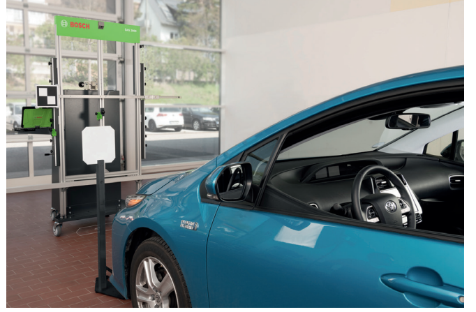
Toyota ön kamera: Bir veya birden fazla hedefle sıralı kalibrasyon. Mesafe ölçüm desteğinin OEM gereksinimlerine göre son derece hassas şekilde konumlandırılması.
