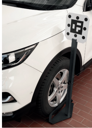
Nissan ön radar + kamera: Yazılım tabanlı mesafe ölçümü, özellikle 2-4 metre mesafelerde son derece kullanışlıdır. Bu, atölyenin verimliliğini artırır. Tekerlek merkezi referansı için göstergeli mesafe ölçüm desteği.
