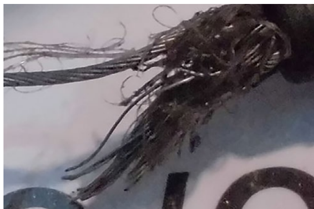
Torn brake cable
