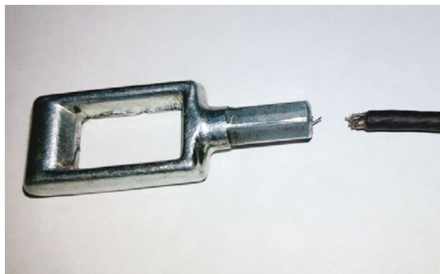
Torn brake cable
