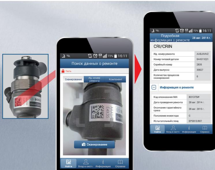
Просто отсканируйте код маркировки при помощи мобильного приложения QualityScan и получите необходимые данные об отремонтированном компоненте
