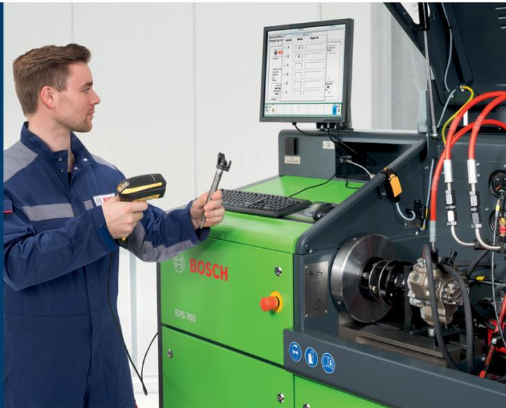
Дизельный специалист сканирует код маркировки компонента и осуществляет его привязку к результатам испытания
