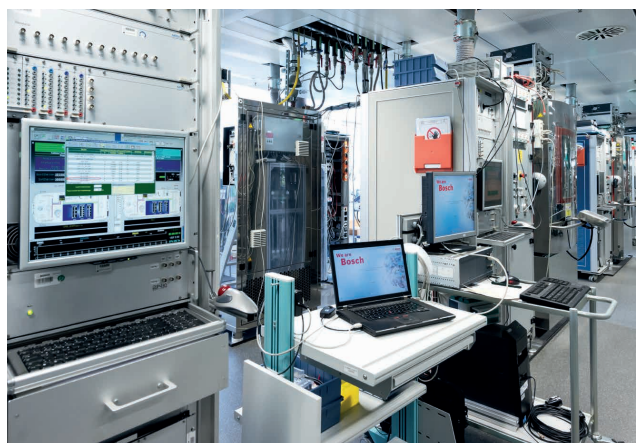
Стенди безперервної роботи у лабораторії високих технологій: своєю високою динамікою ENV6 сприяє високій продуктивності та довготривалому терміну служби сучасних гальмівних систем.
