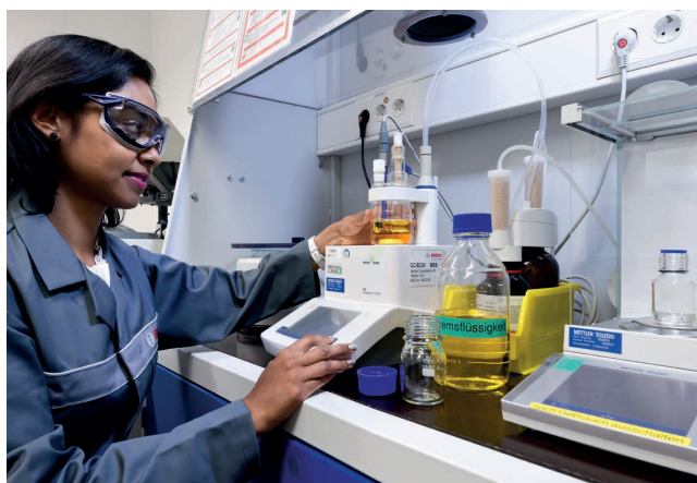
Результати випробувань Bosch ENV6 в лабораторії: У центрі розвитку Bosch гальмівна рідина піддається хімічним випробуванням.
