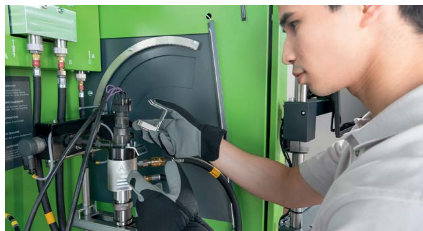
Bosch DCI 200: стенд для індивідуального тестування форсунок розширює потенціал будь-якої СТО
