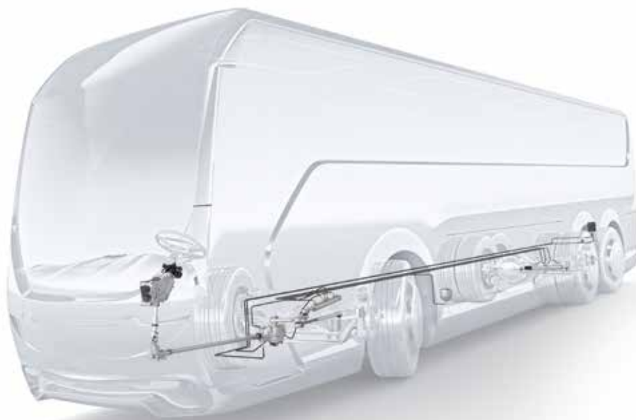
Принципова схема системи управління задньою віссю для автобусів
