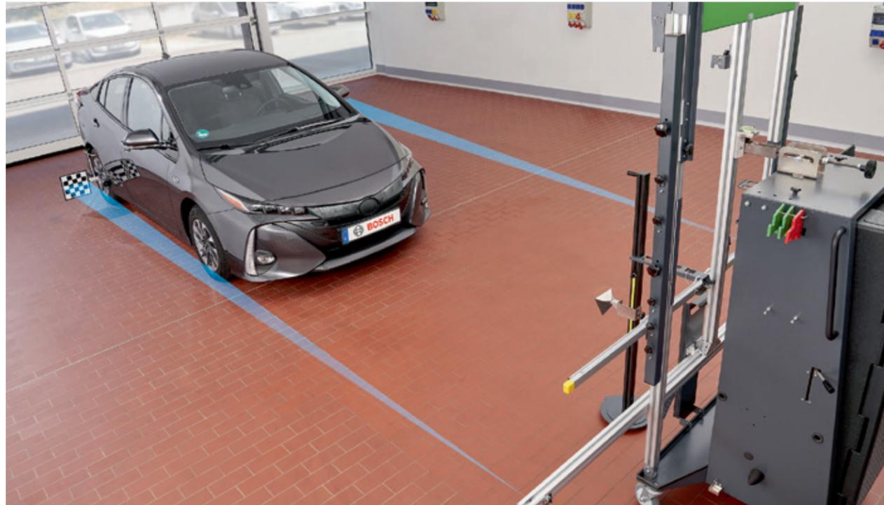
Ausrichtung des CTA 120 für Frontradar Sensoren mit Hilfe des DAS 3000
