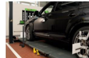
Hebebühnen Offset als Niveausgleich zum höherstehenden Fahrzeug bei Überflur-Hebebühnen
