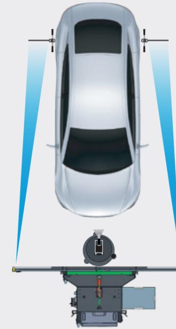
Ausrichtung des CTA 120 für Heckradar Sensoren mit Hilfe des DAS 3000
