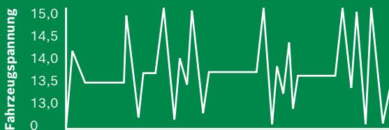
Batteriebelastung bei Start/Stop und Bremsenergieerückgewinnung
