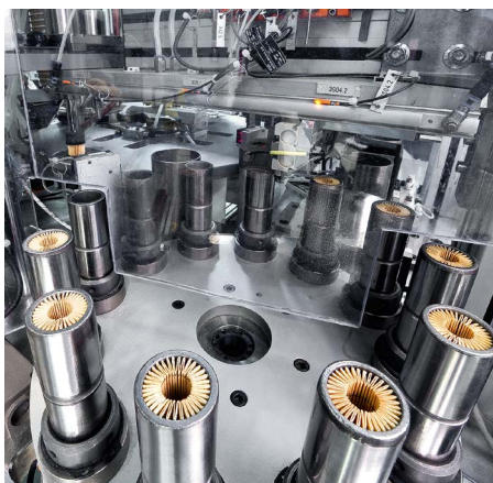
Produktionslinie für Denoxtronic-Filter
