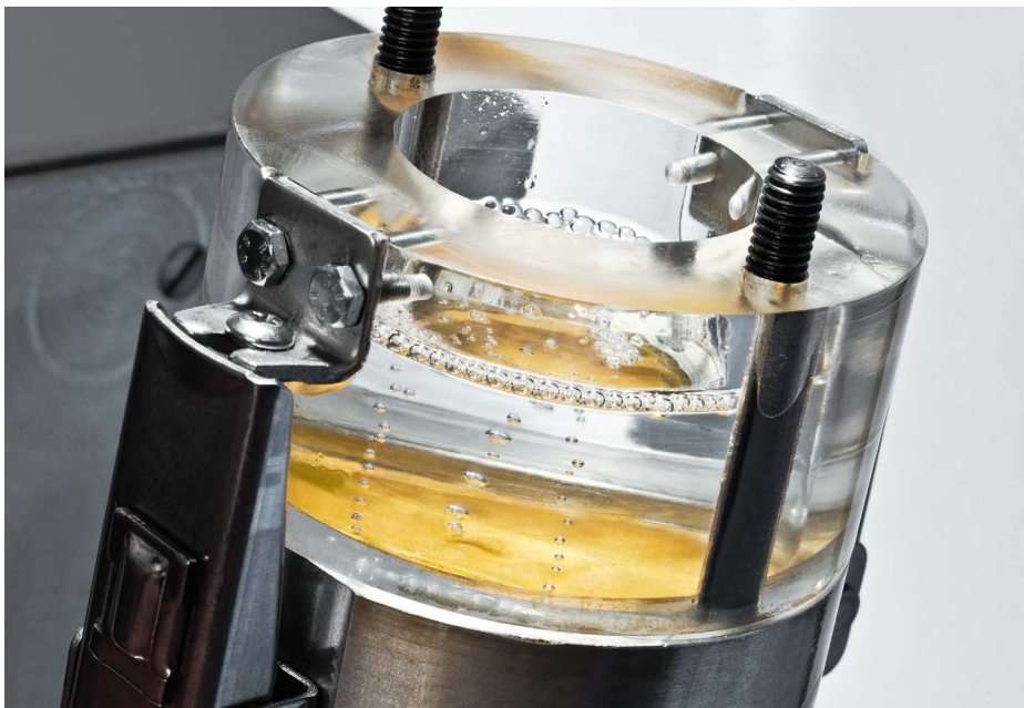
Messung der maximalen Porengröße (DIN ISO 2942)
