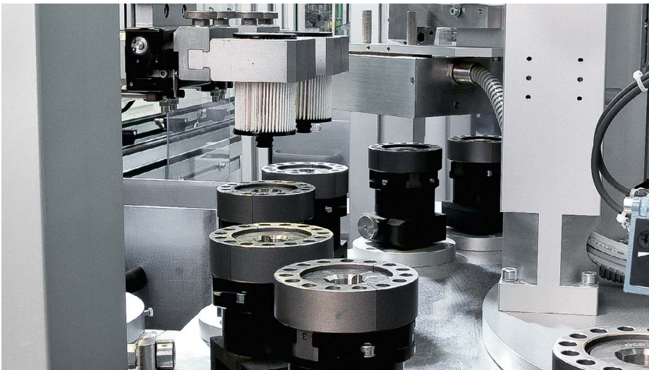
Verbinden von Kunststoff-Filterdeckel mit geschlossenem Faltenstern durch Infrarotschweißen
