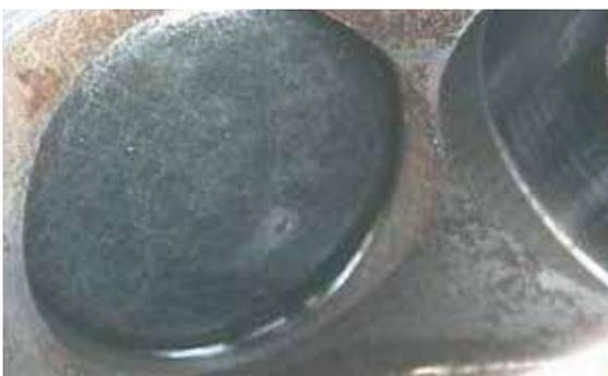
Korrosion am Hochdruckpumpen-Gehäuse
