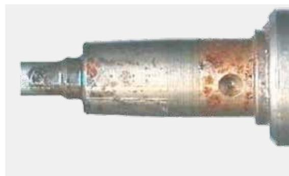
Korrosion am Injektor
