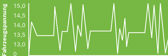
Batteriebelastung bei Start/Stop und Bremsenergieerückgewinnung
