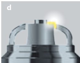
Electrodo lateral – superficie de aislador – electrodo central
