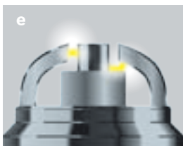
Electrodo lateral – electrodo central o electrodo lateral – superficie de aislador – electrodo central
