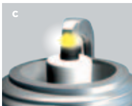
c Elettrodo di massa profilato – elettrodo centrale
