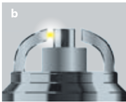
Eléctrodo lateral – Eléctrodo central
