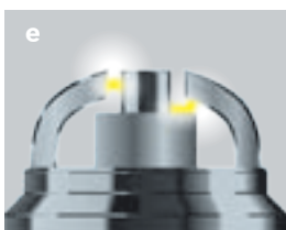
e Boční elektroda – střední elektroda nebo boční elektroda – povrch izolátoru – střední elektroda
