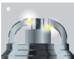
e Electrode latérale – Electrode centrale ou électrode latérale – Tête d'isolateur – Electrode centrale
