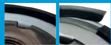
Hochwertige Dichtung aus Spezialgummi verhindert Ölverlust Beschädigte, poröse Dichtung
