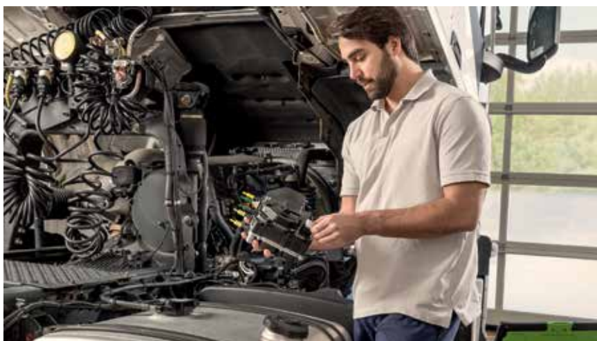
Austausch eines Bosch-Fördermoduls am Nutzfahrzeug
