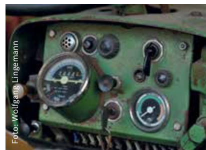
Geräteträger Fendt F225GT (1961–1965) mit Glühüberwacher, Drucktaster, Drehschalter für Licht, Zugschalter und Glühstartschalter von Bosch.
